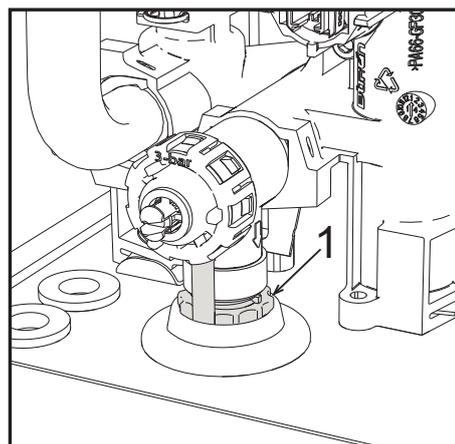
fig. 17- Válvula de seguridad con grifo de descarga
