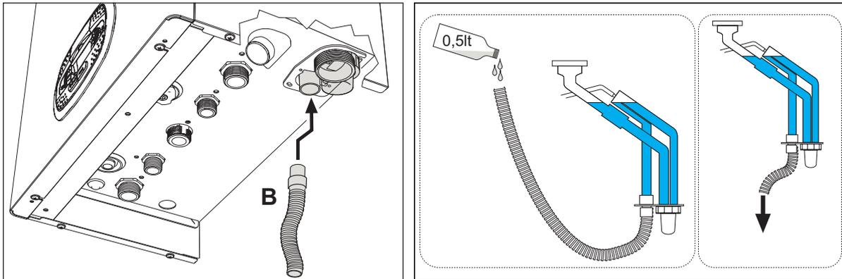
fig. 28- Conexión de la descarga de condensados
