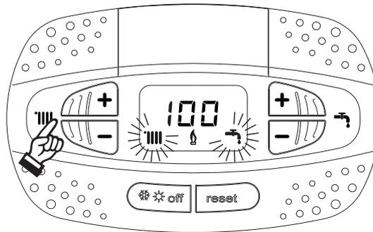
fig. 31- Modo TEST (potencia de calefacción = 100 %)
