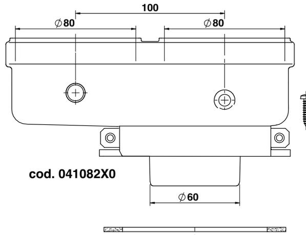
fig. 24- Accesorio inicial para conductos separados
