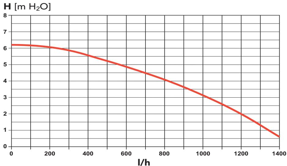
fig. 61- Carga hidrostática residual disponible en la instalación
