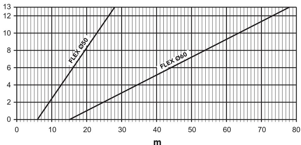
fig. 26- Gráfico para seleccionar el parámetro chimenea
