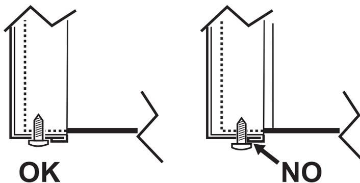
fig. 33 - Posición correcta del panel frontal
