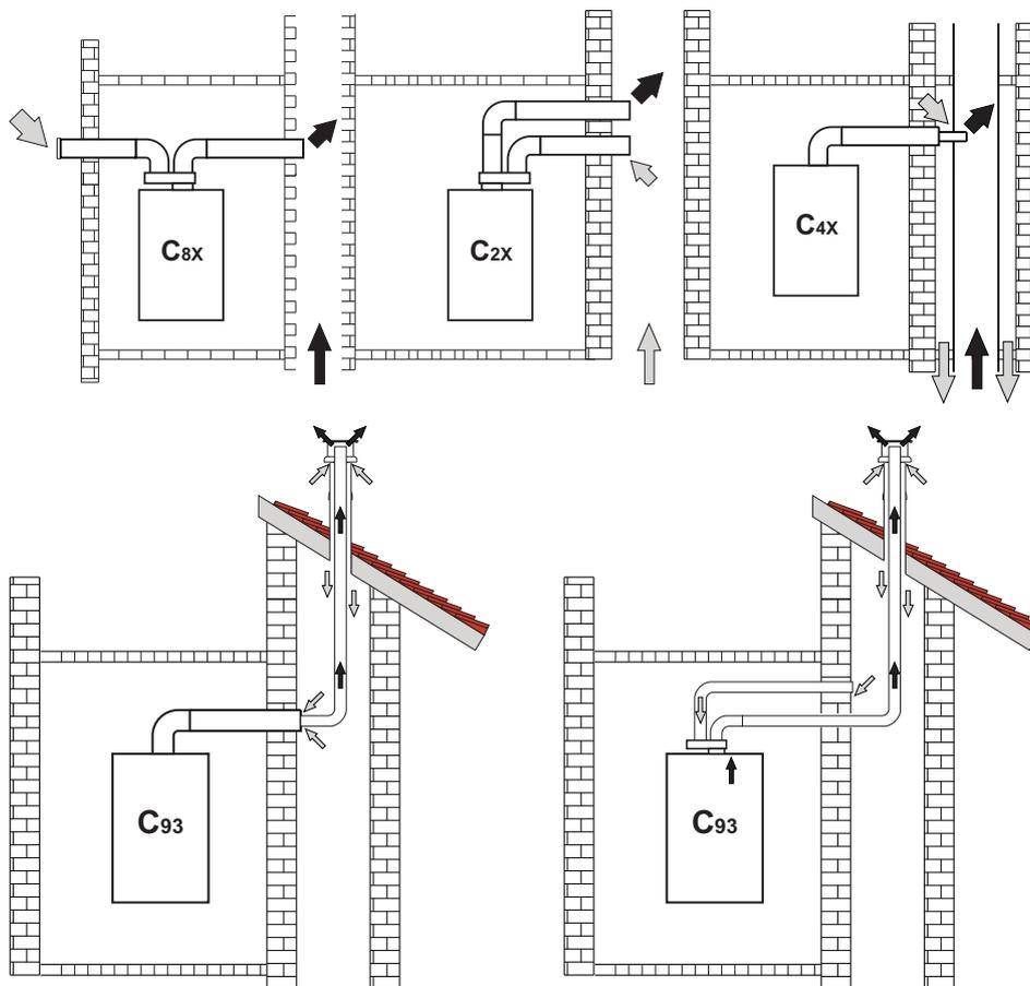
fig. 27- Ejemplos de conexión a chimeneas (⇨ = aire / ⇨ = humos)
