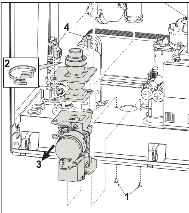
fig. 34- Sustitución de la válvula de gas
